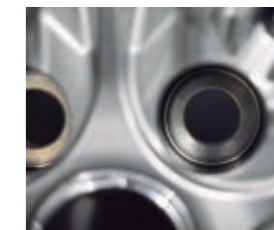
ボルト(ナット)座面形状:平座
